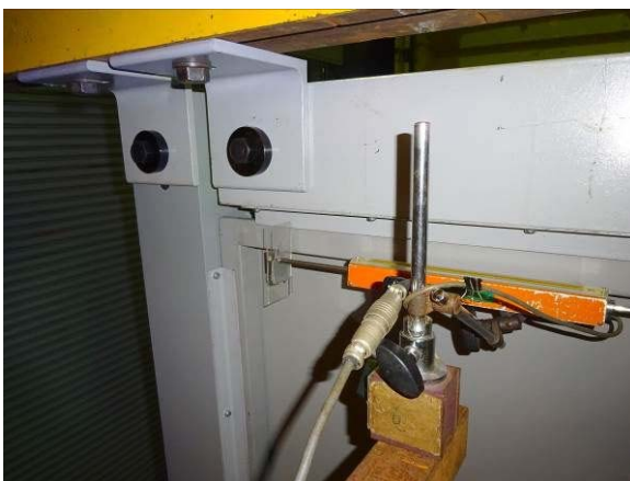
写真5 上枠の変位計設置状況
