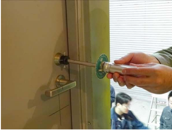
写真7 サムターンの解錠トルク測定状況
