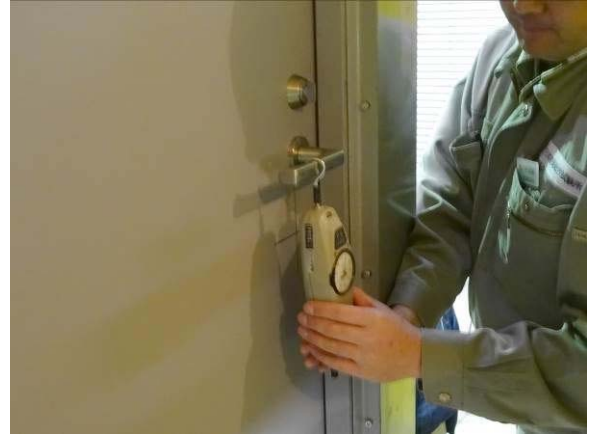
写真8 レバーハンドルの解錠トルク測定状況
